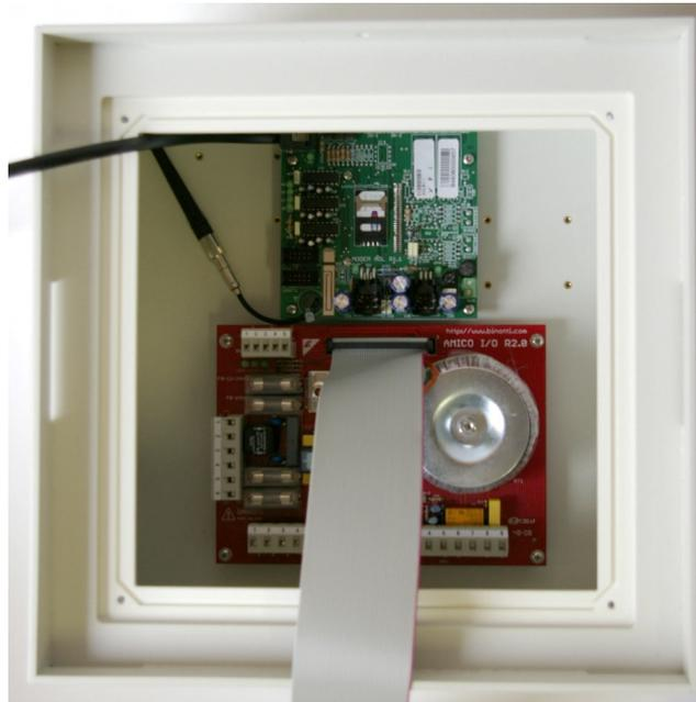
Colocación de la tarjeta de módem GPRS AmicoOnLine (Figura 10)
