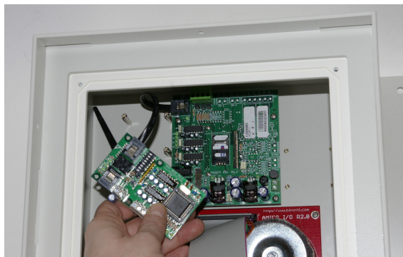
Instalarea modulului AmiBus (Figura 11)
