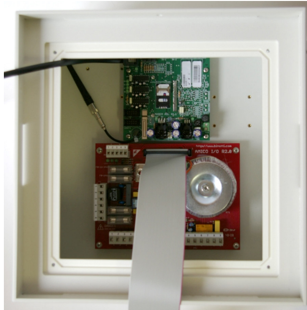
Poziționarea modem card AmicoOnLine GPRS (Figura 10)
